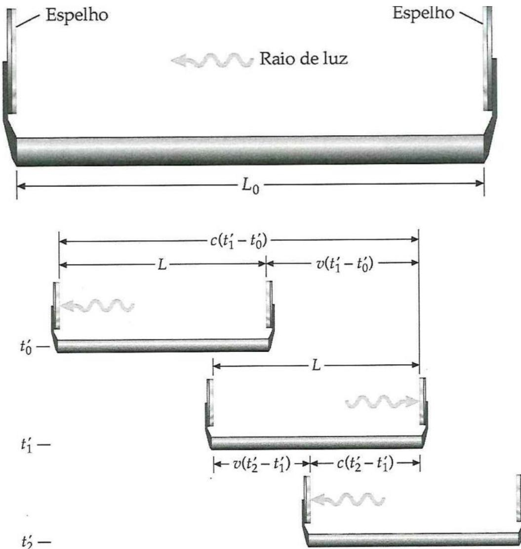
No SRP (Sistema de Referência Próprio) o comprimento do relógio de luz é  $L_0$  e o tempo entre marcas (quando a luz bate nos espelhos) é  $T_0 = \frac{2L_0}{c}$
