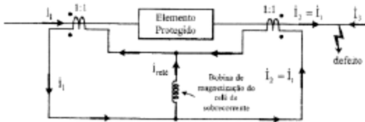
DEFEITO EXTERNO A ZONA PROTEGIDA
